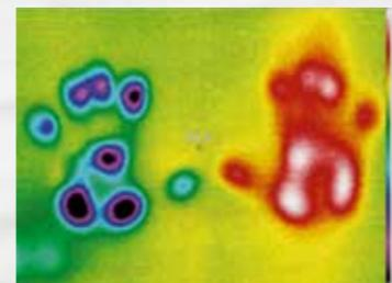
Es kann beobachtet werden, dass die Flachstapete die Wärme nicht an die Wand abgibt, sondern in sich aufnimmt. Sie wirkt somit isolierend.
